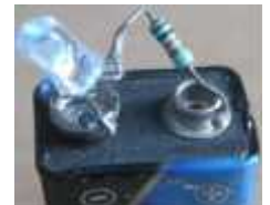
Une DEL placée en série avec une résistance.
