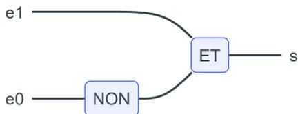
5.c) Dessiner un circuit permettant de sélectionner le périphérique 0.
